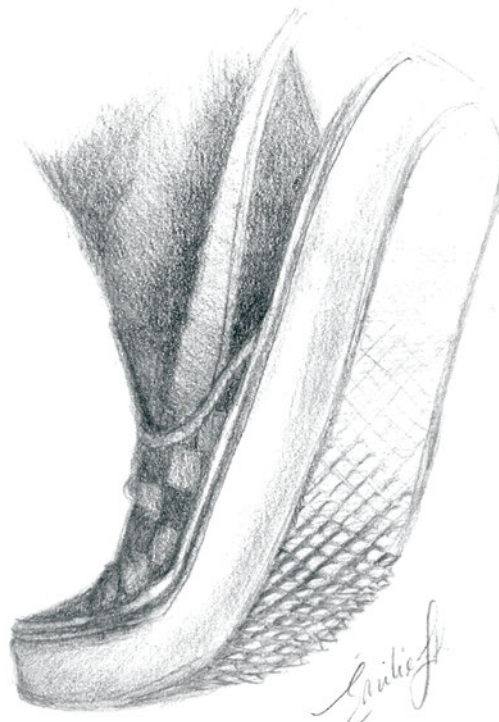
Attache de chaussure antidérapante inspirée de la peau de serpent. Illustration : Emilie Forget-Klein
